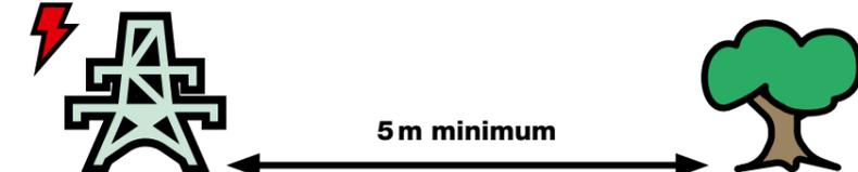
**Dans la mesure où établir cette distance est impossible, la ligne doit être coupée.**
