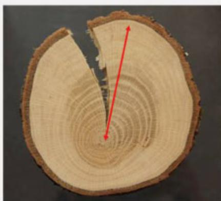
Lors de la maturation du bois de tension, les parois des fibres se rétractent dans le sens longitudinal, agissent comme de multiples petits haubans qui installent progressivement une tension mécanique formidable. Ce **bois de tension** tire lentement le tronc vers le haut et le redresse par courbure de sa base (figure 1A). Le bois est donc à la fois système porteur de l'arbre (son « squelette ») et système moteur pour le mouvement de redressement (ses « muscles »).
